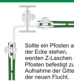
Sollte ein Pfosten auf der Ecke stehen, werden Z-Laschen am Pfosten befestigt zur Aufnahme der Gitter in der neuen Flucht.
